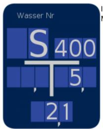
Hinweisschild für den Schieber einer Leitung mit 40 Zentimeter Innendurchmesser (DN 400) bietet, der sich 5 Meter rechts und 2,1 Meter vor diesem Schild befindet.
